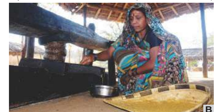
A - तिरही से तेल निकालने के लिए सरसों का प्रसंस्करण // Processing of Mustard for oil extracting through Tirhi. B - तिरही से तेल निकालने का एक दृश्य। / A view of oil extracting from Tirhi.
